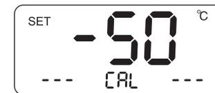
注：用户在更换发热芯或手柄时，如发现温度不准确，可以通过更改此项参数进行校准。操作如下：
