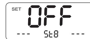
图5-2（待机功能关闭，关加热功能也关闭）
